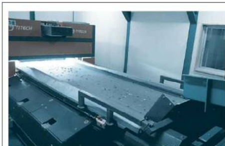
【 破碎された小型家電を分別する高度センサー選別機 】
