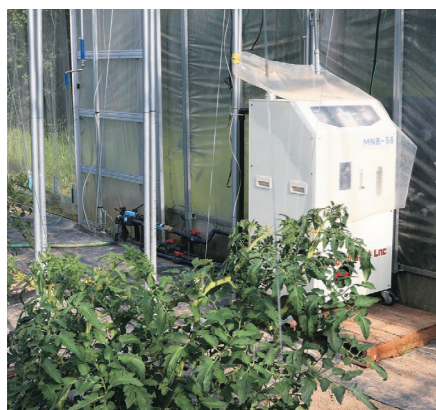
トマト栽培温室内に設置されたUFB水製造装置
